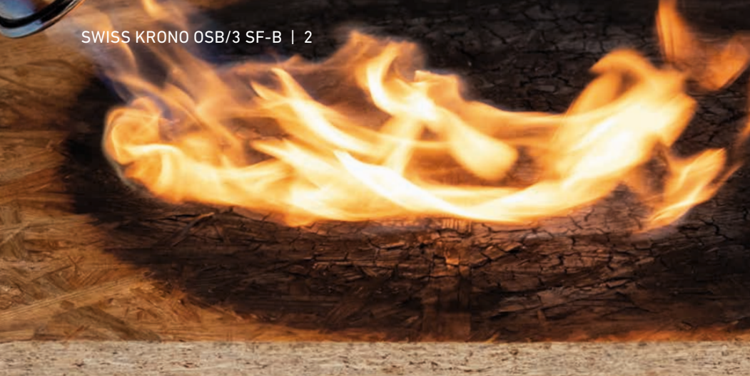
SWISS KRONO OSB/3 SF-B bildet durch Verkohlung eine brandhemmende Schicht
